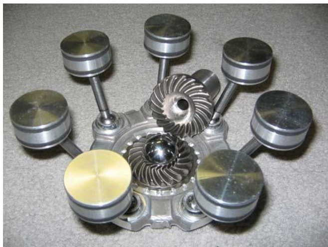
Центральный шар и шестерни в нормальном состоянии
