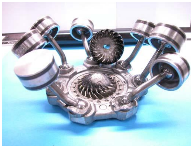
Центральный шар и шестерни после перегрева
